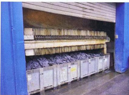
Undichtigkeiten beim Plattenpaket können zum Austreten der Suspension führen, was wiederum eine Gefahrenquelle für den Mitarbeiter darstellt. Die Vollautomaten der Aquachem GmbH arbeiten dagegen mit abgedichteten Filterplatten, einer SPS-Steuerung sowie weiteren verfahrenstechnischen Besonderheiten rund um die Uhr sauber und zuverlässig
