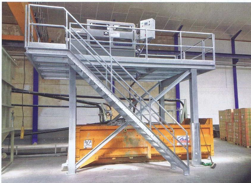
Da die Automaten der AF-Serie nahezu beliebig oft entleert werden können, kann die Presse relativ klein gebaut werden. Bei gleichem Format braucht der Vollautomat von Aquachem nur etwa ein Sechstel der Fläche einer konventionellen Presse
