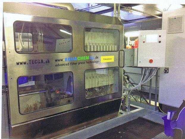
Undichtigkeiten beim Plattenpaket können zum Austreten der Suspension führen, was wiederum eine Gefahrenquelle für den Mitarbeiter darstellt. Das kann mit den Vollautomaten der Aquachem GmbH nicht mehr passieren. Diese arbeiten dank abgedichteter Filterplatten, einer SPS-Steuerung sowie weiterer verfahrenstechnischer Besonderheiten rund um die Uhr sauber und zuverlässig. Alle Abbildungen: © Aquachem GmbH
